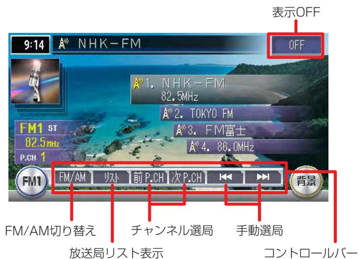
FM/AM切り替え 放送局リスト表示 チャンネル選局 手動選局 コントロールバー
