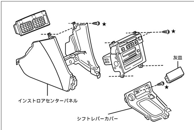
(1) 灰皿、 印ネジ、シフトレバーカバーを取外し、センターパネルを取外します。
