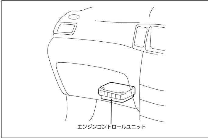
(1) エンジンコントロールカバーの2ヶ所のクリップ取外し、カバーのフタを開けます。
