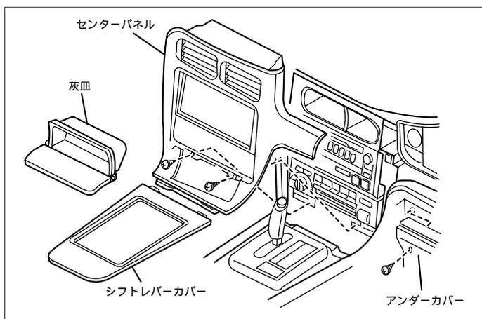
(1)シフトレバーカバー、灰皿、印ネジ、アンダーカバー(一部)を外し、センターパネルを取外します。
