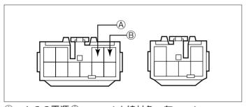
A C C電源⊕ (\*線材色 灰 )B:バックアップ電源⊕ (\*線材色 青 - 黄)
